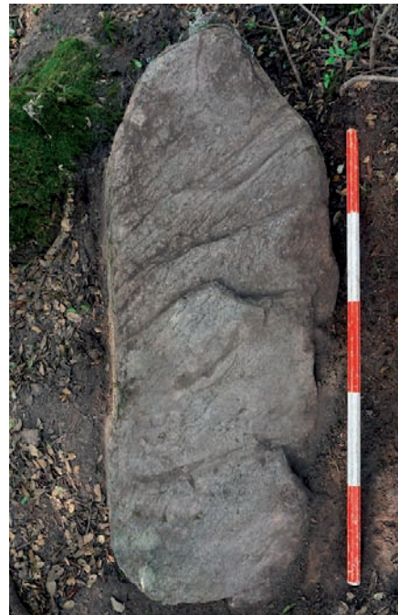
Esempio di campione di anagenite fine prelevato da un affioramento di Verrucano a Valdidonna e foto dell'affioramento stesso, da notare la disposizione la geometrica delle foliazioni che ne facilitano la lavorazione.
