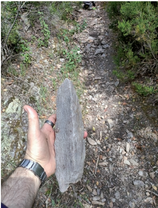
Esempio di campione di anagenite fine prelevato da un affioramento di Verrucano a Valdidonna e foto dell'affioramento stesso, da notare la disposizione la geometrica delle foliazioni che ne facilitano la lavorazione.
